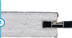
PANNEAU ISOLÉ DOUBLE FACE ALUMINIUM 62 MM AUTOPORTANT Face supérieure laquée blanc RAL 9010. Face inférieure laquée blanc. Mousse isolante (plus de rigidité et atténuation du bruit de la pluie). Panneau de 1 200 mm x 5 000 mm maxi. Clé de jonction entre les panneaux tous les 1 200 mm. Poutre intermédiaire à partir d'une avancée de 4 000 mm.
