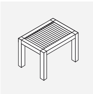
POSE LIBRE 4 poteaux. Lames parallèles ou perpendiculaires.
